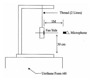
1 METER FROM MICROPHONE TO FAN INTAKE
