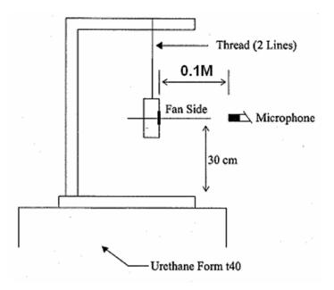
0.1 METER FROM MICROPHONE TO FAN INTAKE
